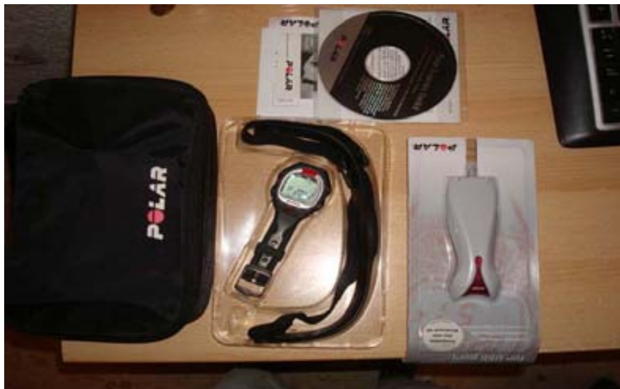
Figura 4. Imagen del pulsómetro Polar s810 (reloj + cinta telemétrica), el CD con el programa para descargar y analizar los datos, y la interface (aparato blanco y rojo) necesaria para descargar los datos del reloj al ordenador.
