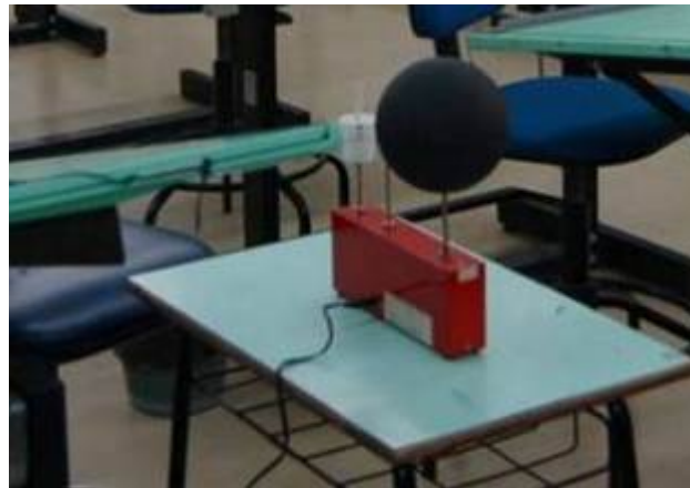
Figura 225 Instrumentos de medición de las variables ambientales - termómetro de globo (Fotografía del autor).
