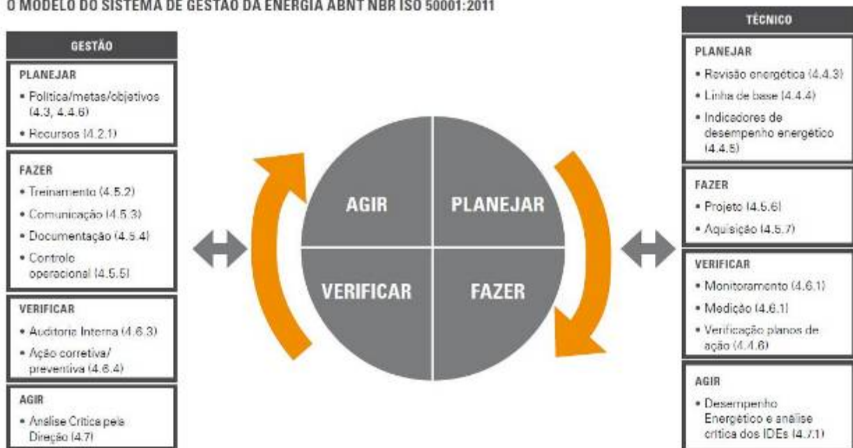
Figura 118 Modelo del Sistema de Gestión de Energía según la ABNT NBR ISO 50001:2011 (Huang 2011, 6).
