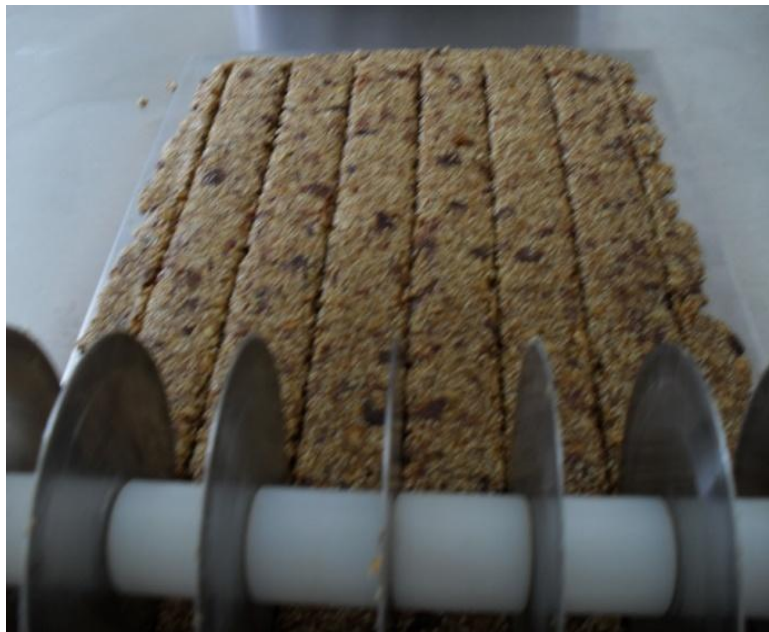
Figura 5.2. Corte de la mezcla a 3cm. para ancho de barras
