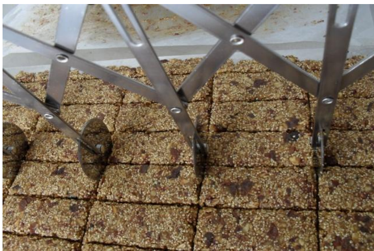
Figura 5.4. Uso del cortador “bicicleta” para dar el tamaño estándar y uniforme de las barras para su horneado, a nivel laboratorio
