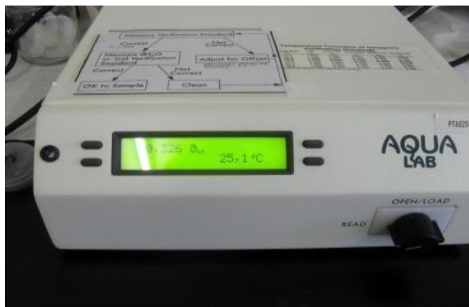
Figura 4.12. Instrumento AQUALAB para obtención de actividad del agua ( a_w )
