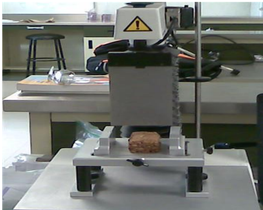
Figura 4.11. Texturómetro modelo “TA2-XT plus”, listo para evaluar barra. Laboratorio de Facultad de Agronomía, UANL.
