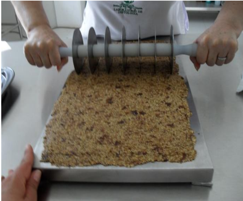
Figura 5.1. Molde rectangular hueco (como marco) y bases que lo sostienen y determinan el grosor de la barra
