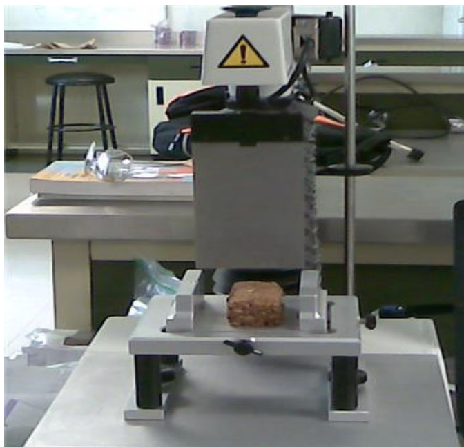
Figura 2. Texturómetro, modelo “TA2-XT plus”. Se muestra la Unibarra colocada en la plataforma para ser tocada y fracturada por la cuchilla de un solo filo (“Warner bratzeler”) y medir la fuerza de corte. Laboratorio de Facultad de Agronomía, UANL.
