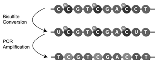
Figura 9: Diagrama de conversión mediante bisulfito de sodio. Imagen adaptada de https://www.epigentek.com/ .
