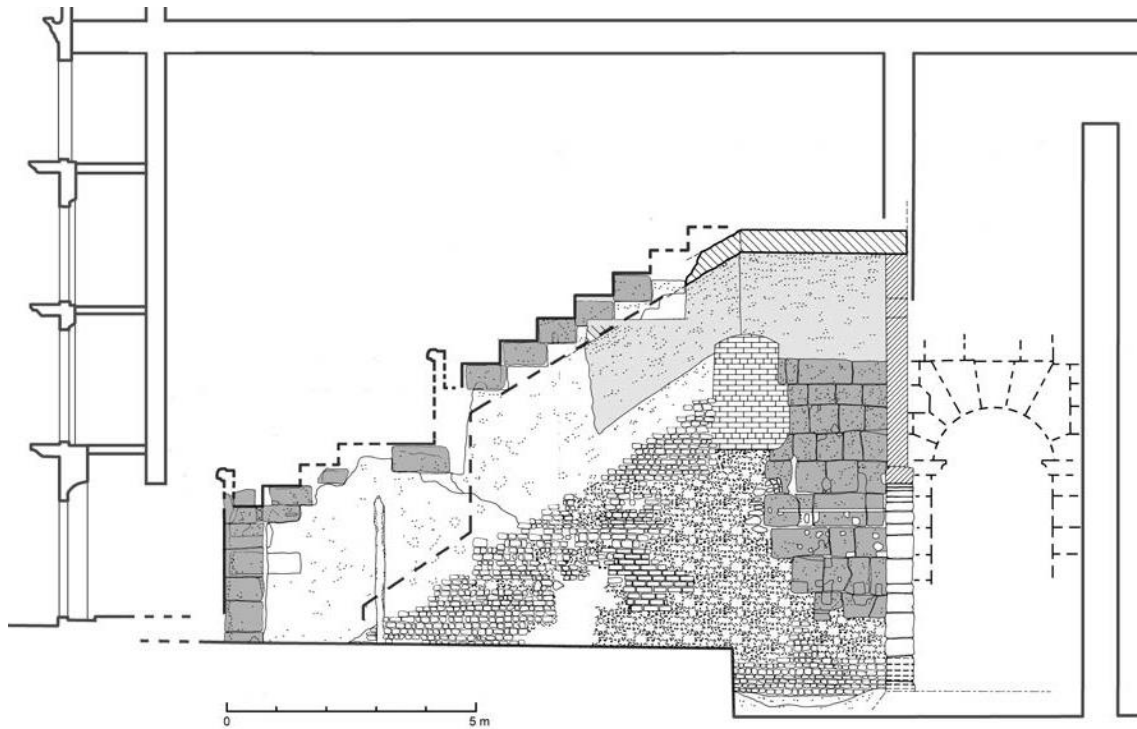
Núm. 17 de la plaça de la Font on es conserven les estructures de les voltes i les grades del circ romà. A dalt alçat d'aquestes estructures; a baix, fotografia de l'estat de conservació d'aquestes. La intervenció arqueològica va documentar una ocupació residencial durant l'antiguitat tardana d'aquesta volta així com un conjunt d'estructures arquitectòniques medievals (arcs) que compartimentaven l'interior de la volta en diferents espais i pisos. TARRACO. ARQUITECTURA Y URBANISMO 2015: 184 i 185.
