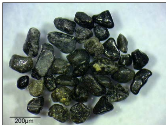
Fig.6: Partículas negras con formas subredondeadas a redondeadas características de apatito Tipo B.
