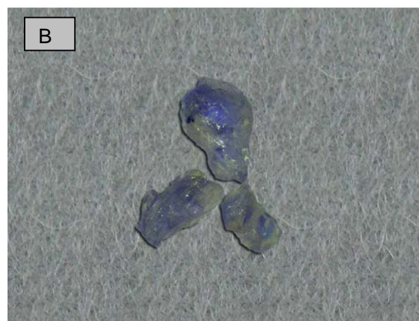
Figura 1: (A) y (B) - Partículas de corindón con formas xenomorfas y bordes de subangulosos a angulosos.
