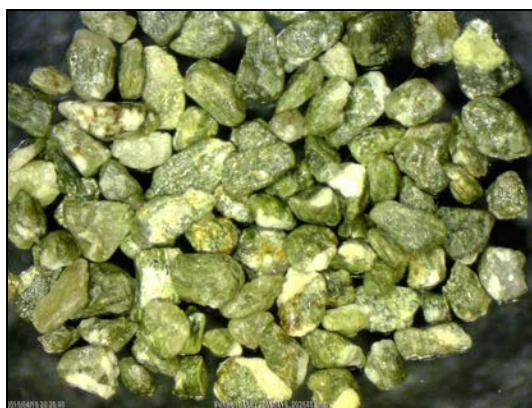
Fig. 6: Epidota de Tipo II. Color verde oscuro algo amarillento, asociada con anortita de color blanco.
