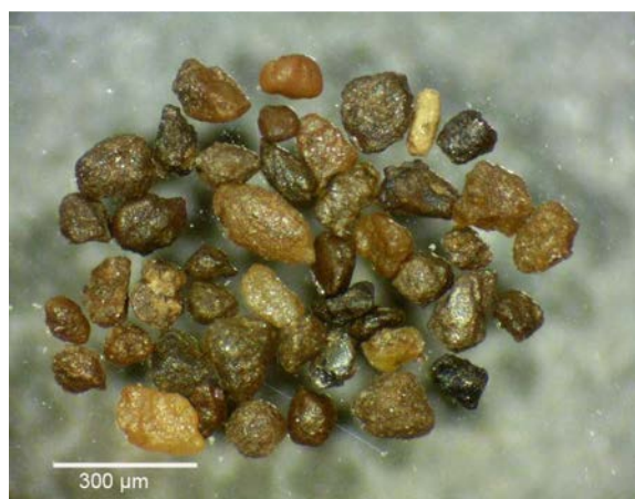
Fig.4: Partículas de APS, de tamaño >100 μm recuperadas a 1,30A en el separador Frantz.
