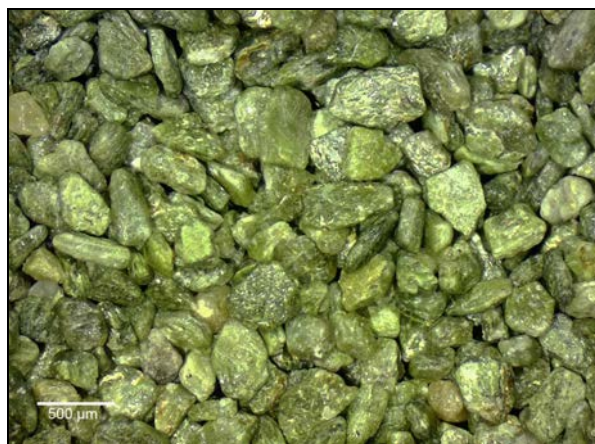
Fig.13: Selección de partículas Tipo II de las mismas características morfológicas de las de la probeta EVO.
