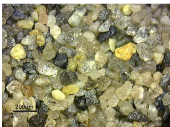
Fig.7: Imagen de la fracción diamagnética donde se observan partículas de apatito Tipo B.
