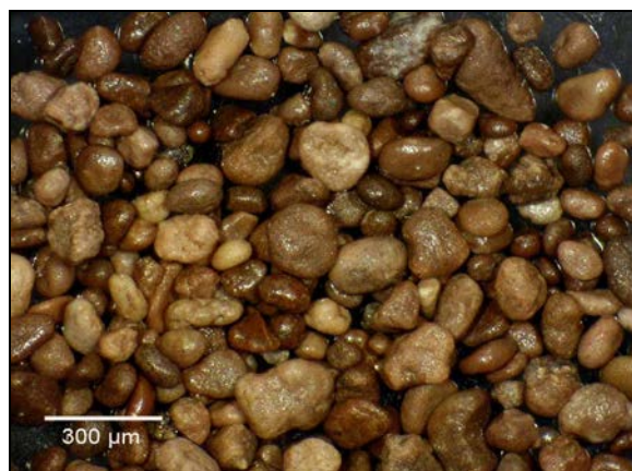
Fig.5: Partículas de APS, de tamaño >100 µm recuperadas a 0,80A en el separador Frantz.
