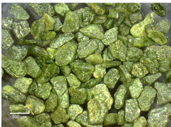
Fig.12: Selección de partículas Tipo II de las mismas características morfológicas de las de la probeta EVO.
