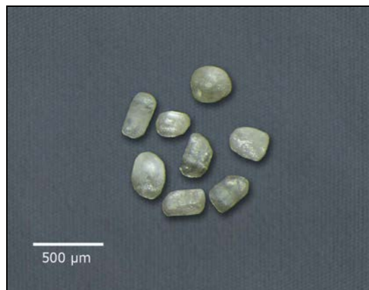
Fig.4: Cristales subhédricos de apatito Tipo A. Bastante rodados. Posiblemente de segundo ciclo.
