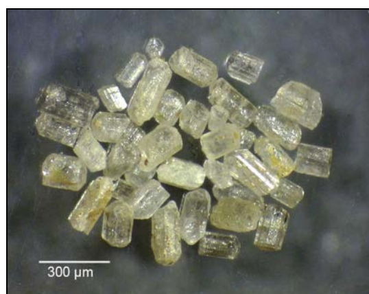
Fig.2: Cristales euhédricos de apatito Tipo A, algunos biterminados. separados de la fracción diamagnética
