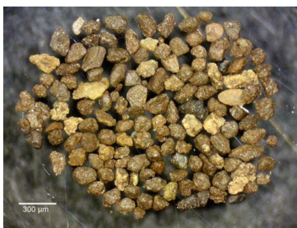
Fig.3: Partículas de APS, de tamaño >100 μm recuperadas a 0,80A en el separador Frantz.
