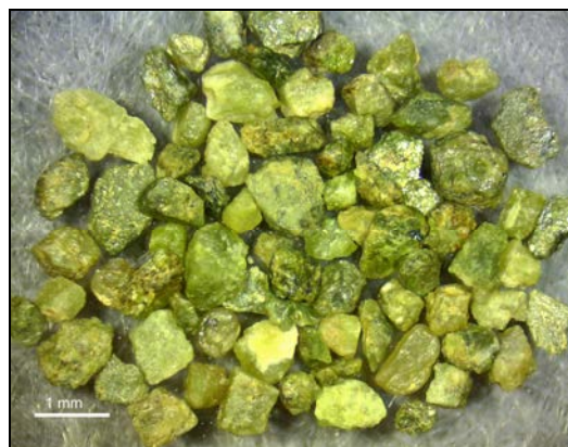
Fig.2: Epidotas de Tipo I. Color verde pistacho amarillento. Con formas angulosas y subangulosas.
