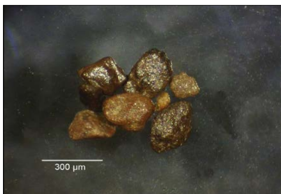
Fig.3: Partículas de APS, de tamaño >100 \mu\text{m} recuperadas a 0,45A en el separador Frantz.
