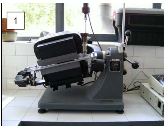
Fig.04: (1) Vista general del separador Frantz Isodynamic LB-1 (2) Detalle del embudo dosificador de partículas. Para evitar atascos no conviene trabajar con partículas superiores a 500 \mu\text{m} .
