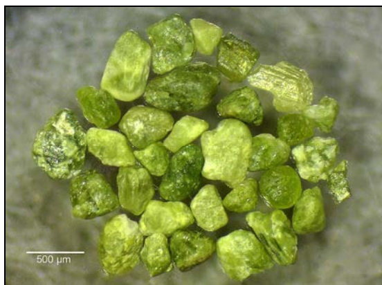
Fig. 1: Epidotas de Tipo I. Color verde pistacho. Algunas formas pseudo prismáticas presentan caras estriadas.
