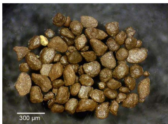
Fig.3: Partículas de APS, de tamaño >100 \mu\text{m} recuperadas a 0,45A en el separador Frantz.
