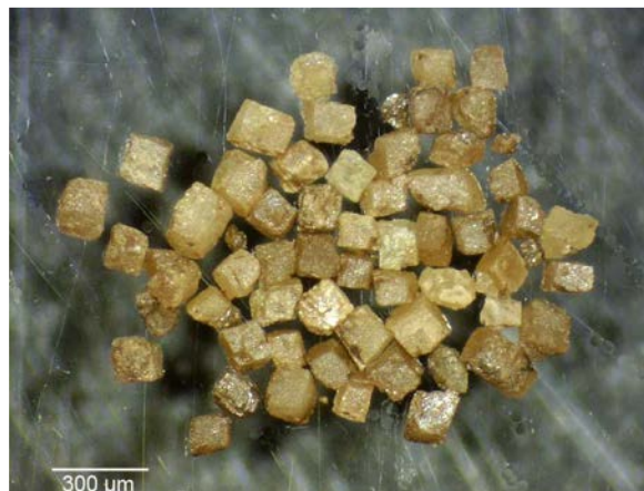
Fig.6: Partículas romboédricas de dolomita de tamaño >100 μm recuperadas a 1,30A en el separador Frantz.
