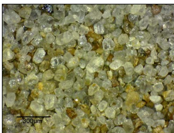
Fig.3: Imagen de la fracción de 1,30A, donde se observan abundantes cristales de apatito Tipo A.
