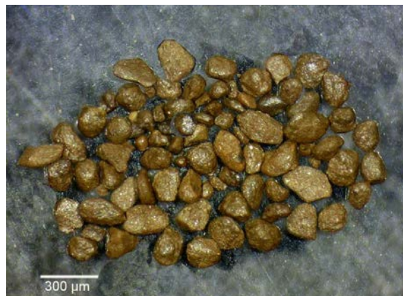
Fig.6: Partículas de APS, de tamaño >100 µm recuperadas a 1,30A en el separador Frantz.
