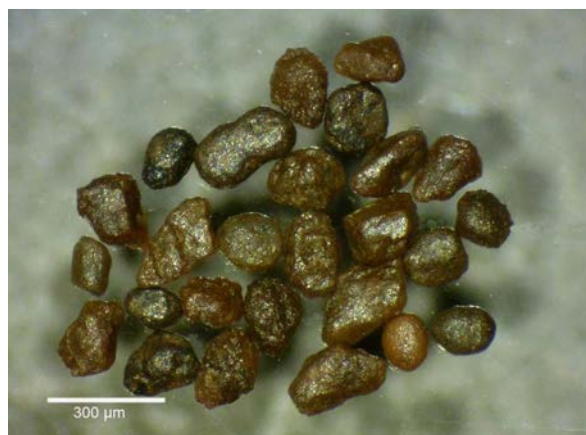
Fig.6: Partículas de Fluorapatitos y APS, de tamaño >100 µm recuperadas a Diamag en el separador Frantz.
