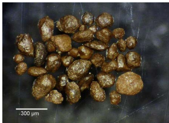
Fig.5: Partículas de APS, de tamaño >100 \mu\text{m} recuperadas a 0,80A en el separador Frantz.
