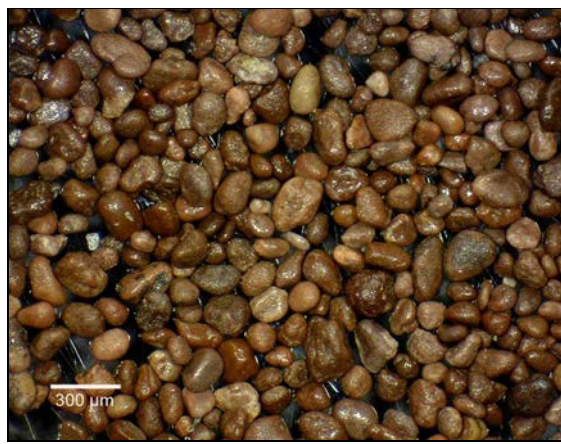
Fig.4: Partículas de APS, de tamaño >100 µm recuperadas a 0,60A en el separador Frantz.
