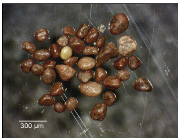
Fig.3: Partículas de APS, de tamaño >100 µm recuperadas a 0,45A en el separador Frantz.
