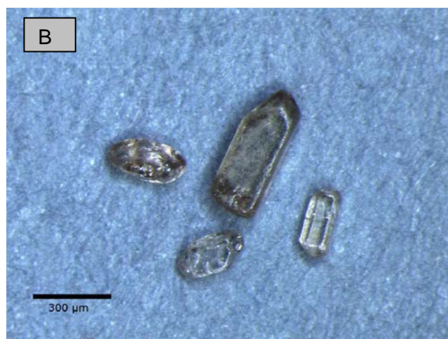
Fig 1: (A) y (B) - Partículas de circón de varios tonos de color, con formas euhédricas y subhédricas. Elegidas de varios afloramientos.
