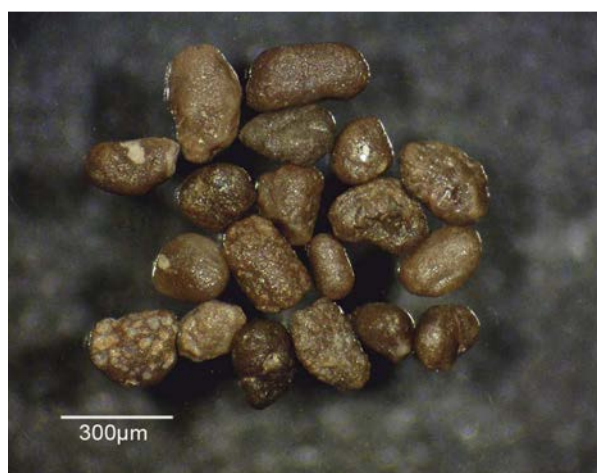
Fig.14: Partículas de apatito de color pardo a marrón recuperadas de la fracción diamagnética de la facies Buntsandstein inferior de Martorell.
