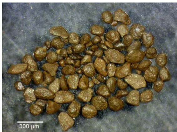
Fig.6: Partículas de APS, de tamaño >100 \mu\text{m} recuperadas a 0,80A en el separador Frantz.
