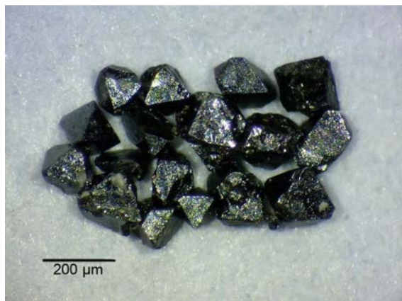
Fig. 4: Fracción ferromagnética donde se han seleccionado formas octaédricas de magnetita.
