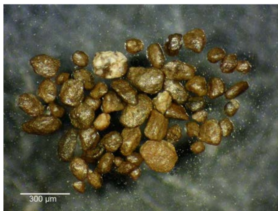
Fig.4: Partículas de APS, de tamaño >100 \mu\text{m} recuperadas a 1,30A en el separador Frantz.
