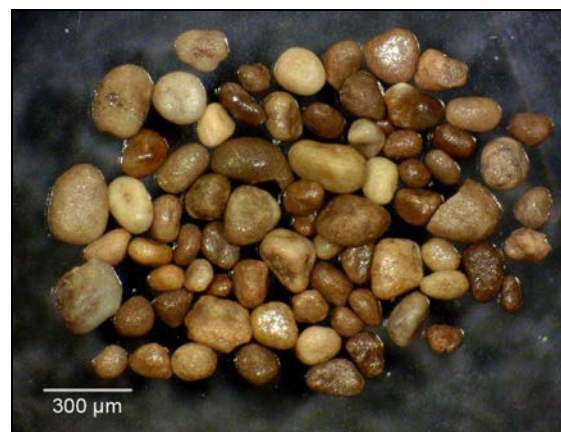
Fig.6: Partículas de APS, de tamaño >100 µm recuperadas a 1,30A en el separador Frantz.
