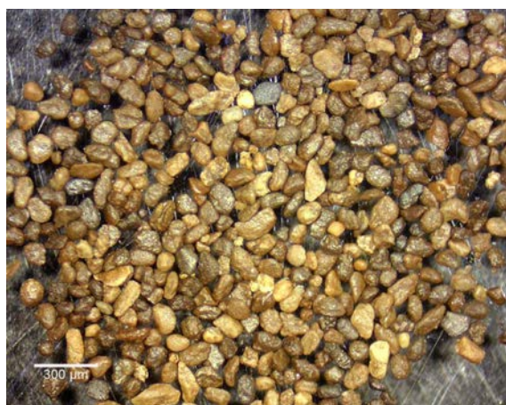
Fig.4: Partículas de APS, de tamaño >100 µm recuperadas a 1,30A en el separador Frantz.
