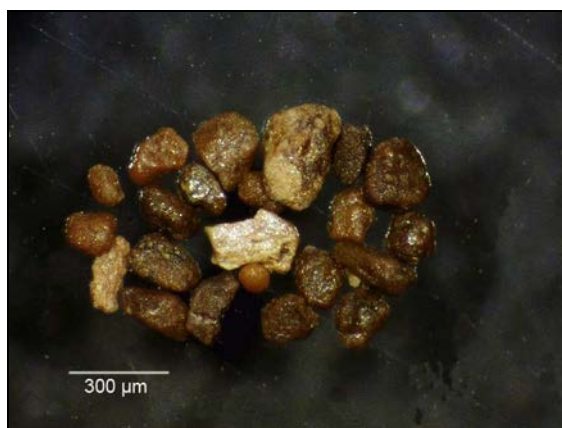
Fig.5: Partículas de APS, de tamaño >100 \mu\text{m} recuperadas a 0,80A en el separador Frantz.
