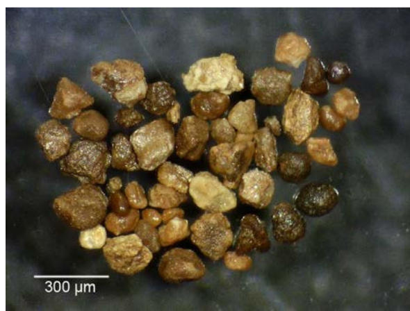
Fig.4: Partículas de APS, de tamaño >100 µm recuperadas a 0,80A en el separador Frantz.
