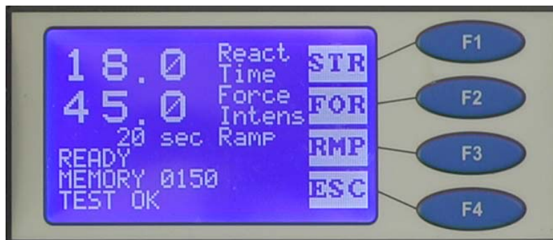
Figura 48. Detalle de pantalla digital con valores de fuerza (gramos) y latencia (segundos).
