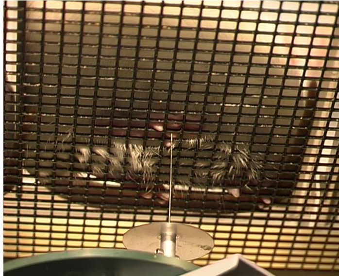
Figura 47. Detalle del filamento perpendicular del Dynamic Plantar Aesthesiometer.
