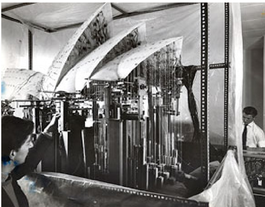
Fig. 3-2-57: Arup. Sydney Opera House maqueta estructural de techumbre B bajo prueba de cargas verticales realizado en el Southampton University (c.1958).
