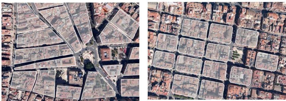
**Figura 3.9** Manzanas en trazado radial (izquierda) y manzanas en trazado ortogonal (derecha)
