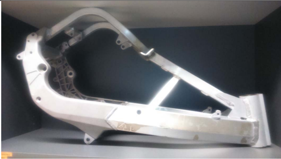
Figura 44. Chasis de motocicleta. Perfilería y cuerpo de fundición de aluminio soldados (cortesía Derbi («Derbi», s. f.))
