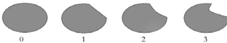
Figura 4. Graduació dels canvis arquitectònics en la superfície cortical de l'os. Secció transversal del radi a nivell d'una inserció de tipus carnos o directa.
