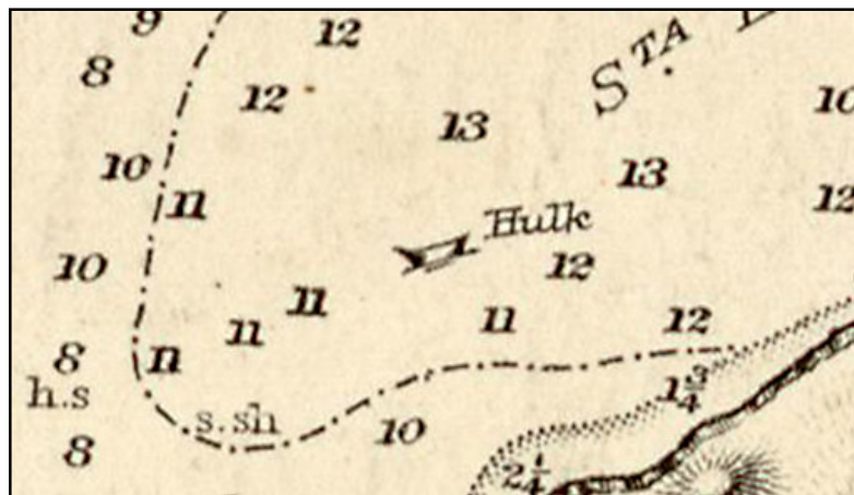
Figura 152: Detalle con simbología de casco de embarcación (Ejemplo 1). Carta náutica "Acapulco Harbour" (1849). Fuente: A.N.C. Referencia: 5033/1944.
