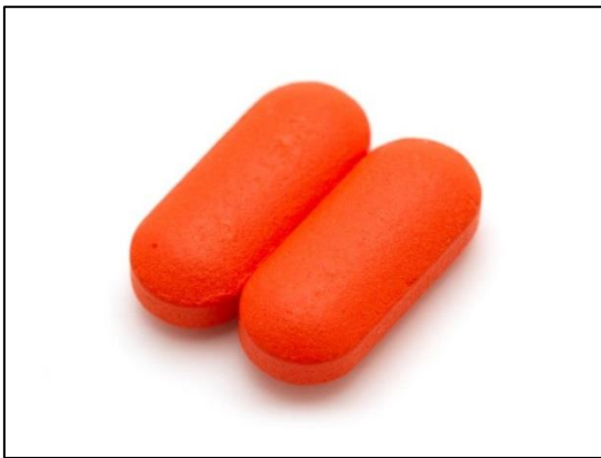
Figura 8 – Adherencia entre comprimidos recubiertos y twinning (57)
