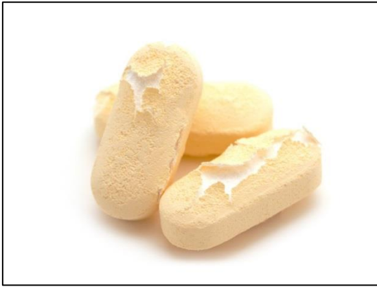
Figura 14 – Comprimidos recubiertos con peeling (57)
