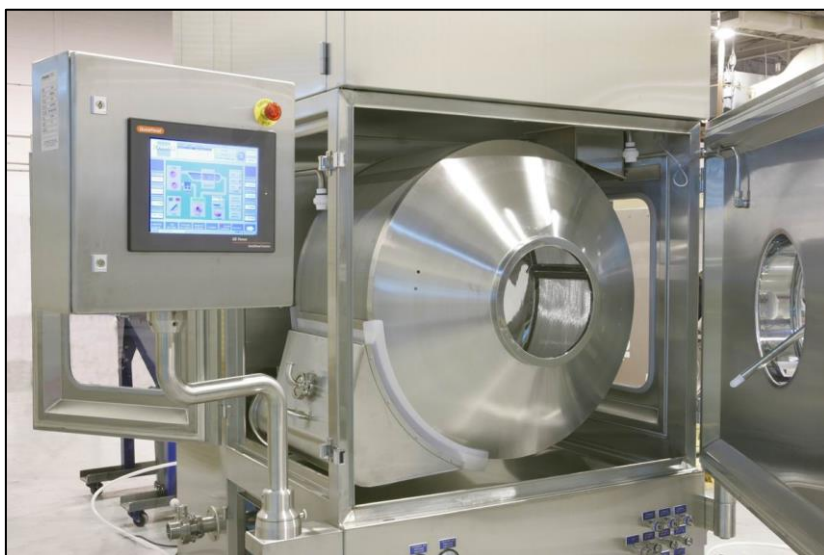
Figura 26 – Imagen del equipo de recubrimiento O'Hara Labcoat IIX (fotografía de elaboración propia)
