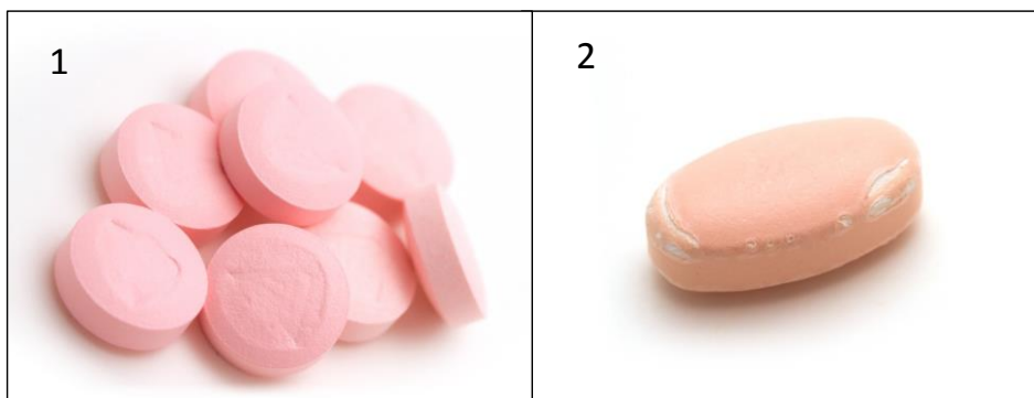
Figura 13 – Erosión de la superficie (1) y erosión de las esquinas o chipping (2) (57)
