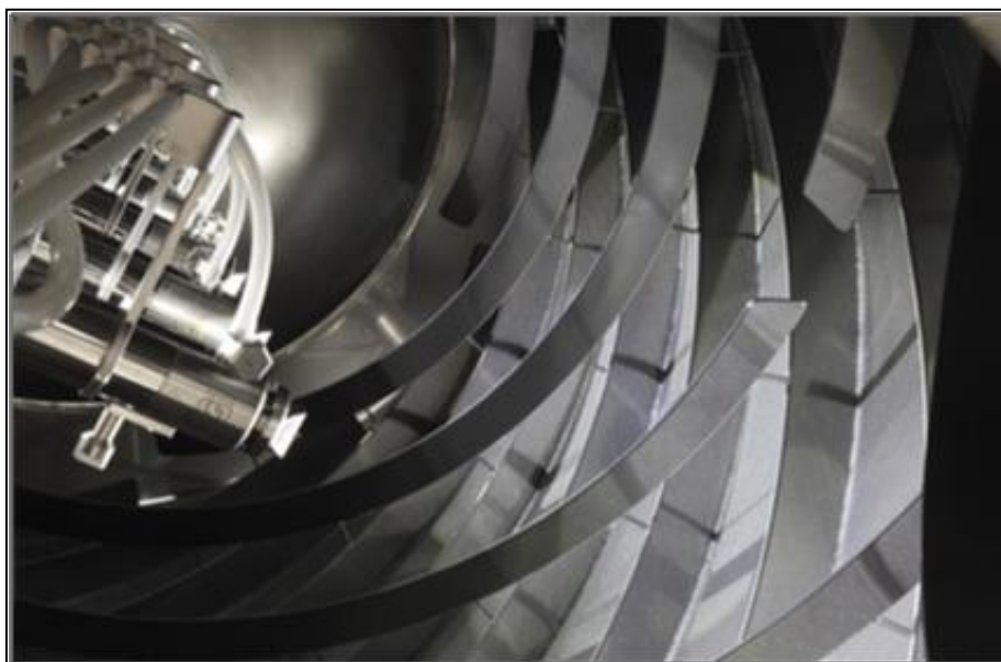
Figura 24 – Diseño de las palas mezcladoras en espiral del bombo Bohle BFC (fotografía de elaboración propia)
