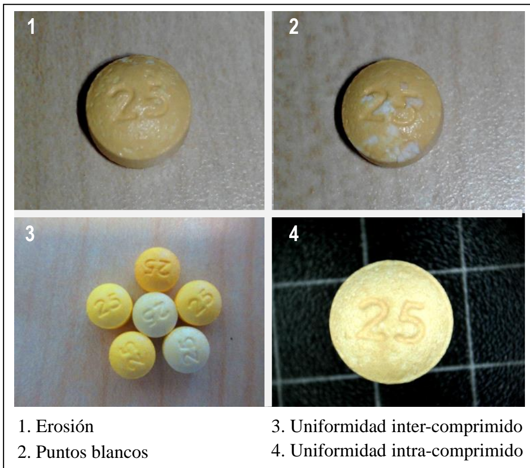
Figura 33- Ejemplos de erosión, puntos blancos y uniformidad de recubrimiento (fotografías de elaboración propia)
