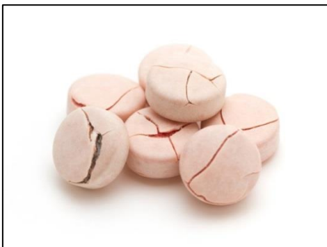
Figura 12 – Ejemplo de cracking o grieta de la película (57)
