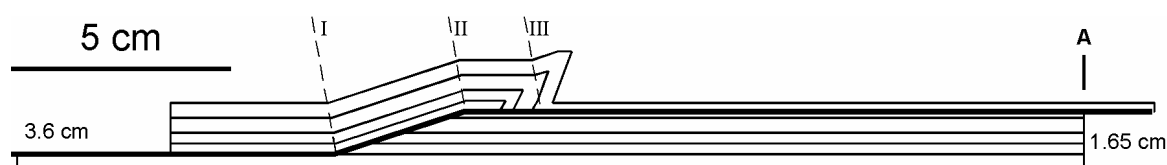
Fig. 5.65.- Desplaçament al llarg d'un replà del plec de propagació de falla associat a l'encavalcament 3 (fig. 5.63). La part del bloc superior que es troba per davant de la línia A es tradueix en engruiximent dels nivells superiors en el model analògic. El paral·lelisme dels plans axials II i III indica que aquesta deformació no suposa cap deformació interna en el replà frontal del bloc superior.
