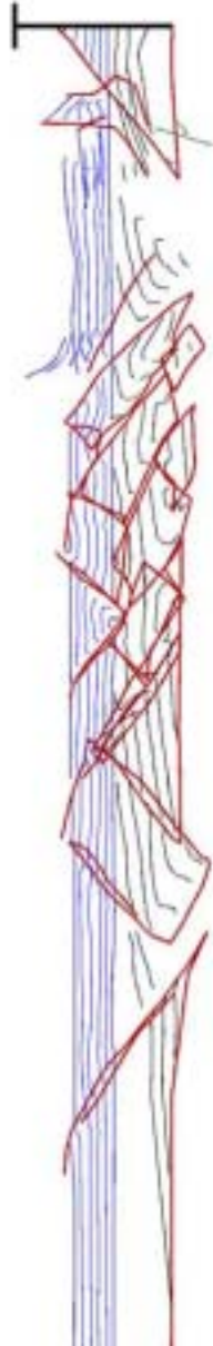
Fig. 5. Comparació entre el model inicial escurejat un 14,25% i la secció restituïda. S'observa que l'algoritme funciona acceptablement per a la part superior de, amb el marcatge horitzontal, però presenta problemes a la part inferior i posterior, degut principalment a l'efecte de vora que aquest algoritme no té en consideració
