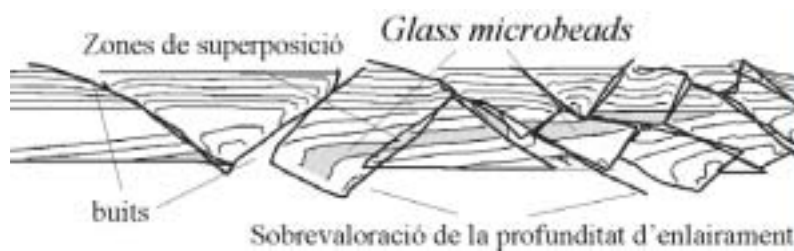
Fig. 5.17.- Reproducció de la part central de la restitució per SSU del model Mdl5prflA04 en la que s'indiquen algunes anomalies característiques d'aquest mecanisme
