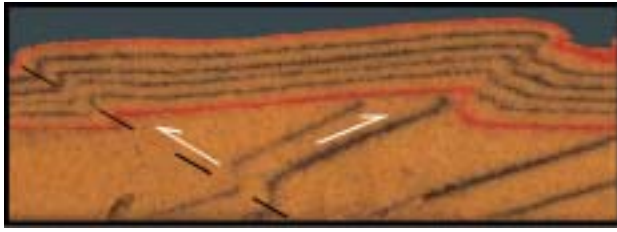
Fig. 4.37.- Detall de l'estructura del model 1 en el que s'observa un retroencavalcament (R7) que aprofita la superfície d'un marcador per lliscar. El gruix de la capa que es troba per sota d'aquest marcador no té origen tectònic.
