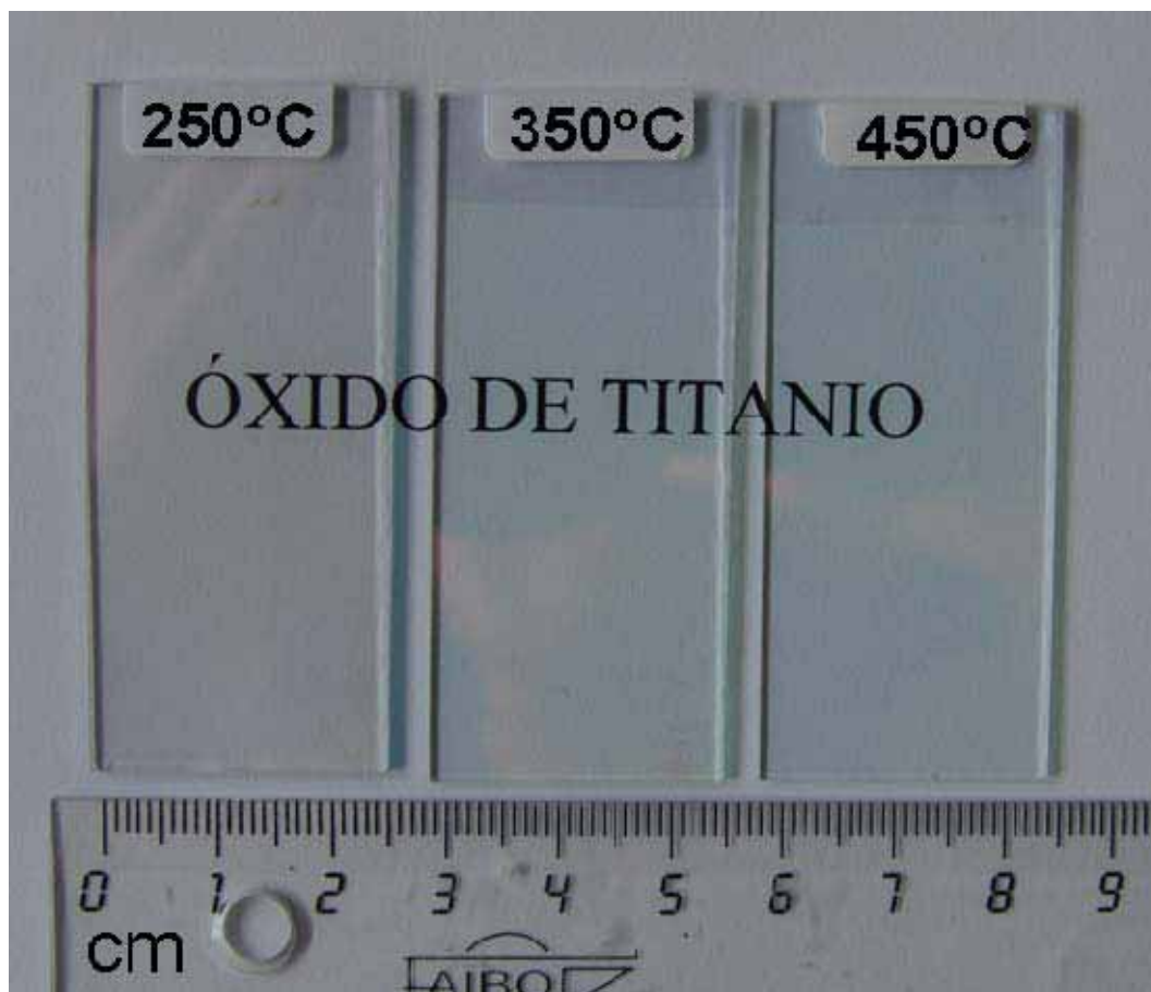
Figura 3.3 Capas de TiO 2 obtenidas por spin coating.
