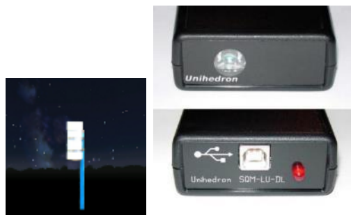
Posición de uso y uso del dispositivo SQM-LU-DL y fotografía ilustrativa
