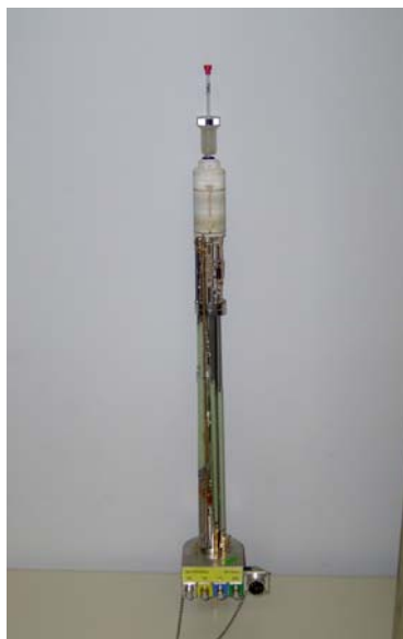
Figura 51 Fotografia d'una sonda triple ^1\text{H} , ^{13}\text{C} i ^{15}\text{N} que permet l'execució d'experiments amb temps compartit (TS).
