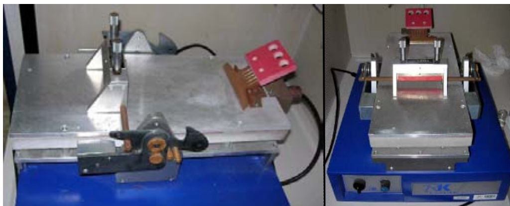
Figura 3.3 Fotografías del aplicador micrométrico RK Print Applicator utilizado para preparar láminas de SPEEK por inversión de fase por evaporación.
