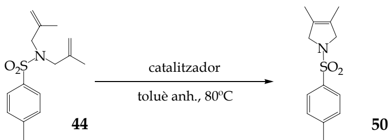
Esquema 53. Metàtesi intramolecular de la N,N -bis(2-metilal·lil)-4-toluensulfonamida, 44 .
