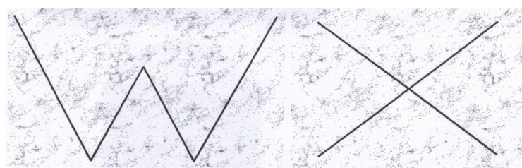
Figura 1.9. Patrones espaciales en W y X para la toma de muestra sistemática.
