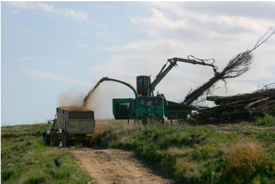
Figura 4. Trituració dels pins cremats a Ventalló. Aquí els arbres eren triturats completament al mateix lloc de tala, per obtenir-ne combustible de biomassa. Fotografia feta l'abril de 2008.
