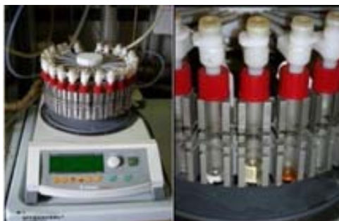
Figura 51. Multireactor amb agitació orbital usat en les reaccions d'oxidació d'alcohols.
