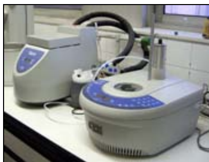
Figura 33. Microones emprat en la reacció de Heck catalitzada per \text{Pd}_{\text{Np}}[41] .
