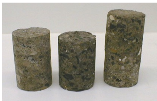
Foto 6.6: EIRSU integradas en un sistema con cemento Pórtland (tratadas con cemento Pórtland).
