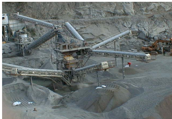
Foto 3.2: Planta móvil de cribado, donde se fraccionó las EIRSU en 5-12 y 12-20 mm.
