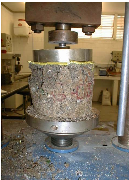
Foto 4.2: Probeta de G-CEM ensayada a compresión.
