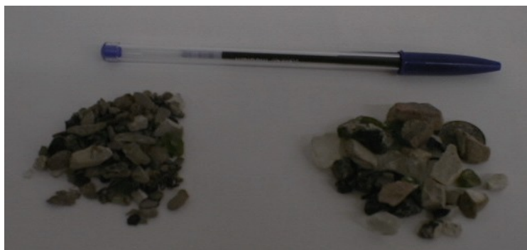
Foto 6.5 Muestras de EIRSU sueltas de la fracción 5-12 (izquierda) y 12-20 mm (derecha).
