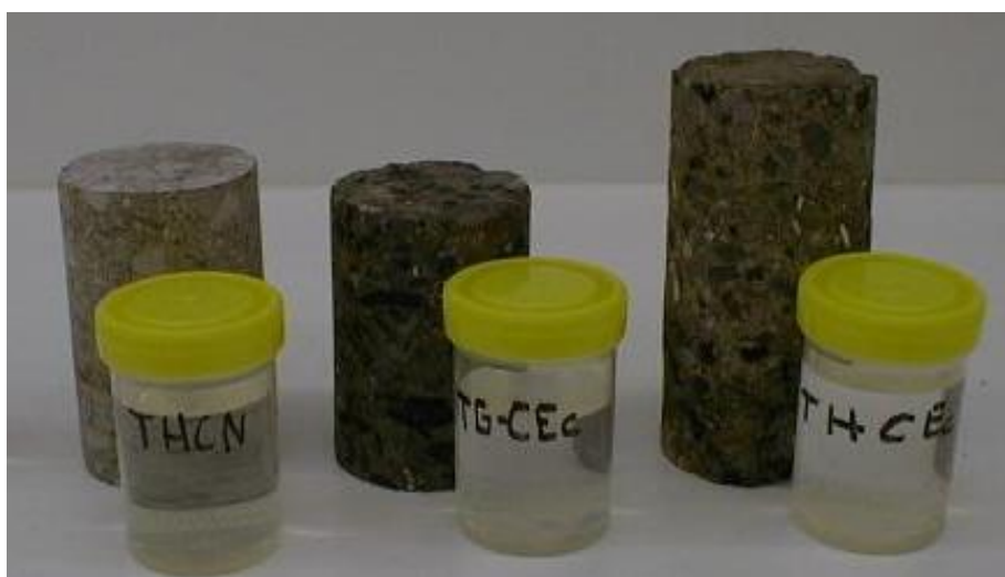
Foto 6.7: Materiales monolíticos sometidos al test de lixiviación NEN 7345.
