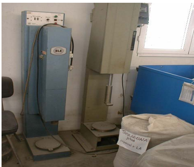
Foto 4.1: Máquina proctor modificado
