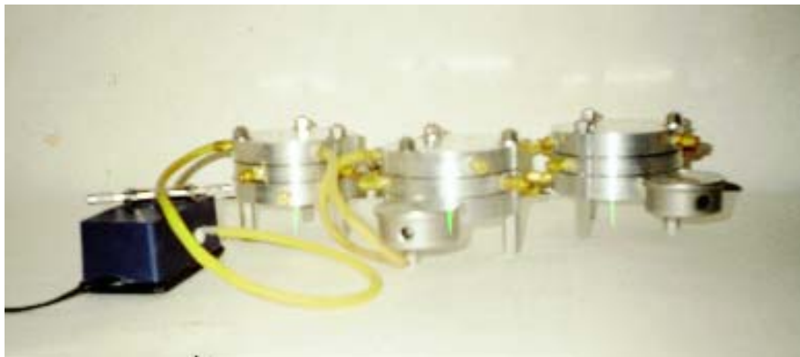
Fig. 3-1. Células estancas de permeabilidad dotadas de manómetro.
