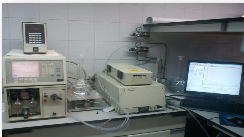
Figura 24. Cromatógrafo líquido HPLC Waters 600 acoplado a un detector de fotodiodos Waters 996.
