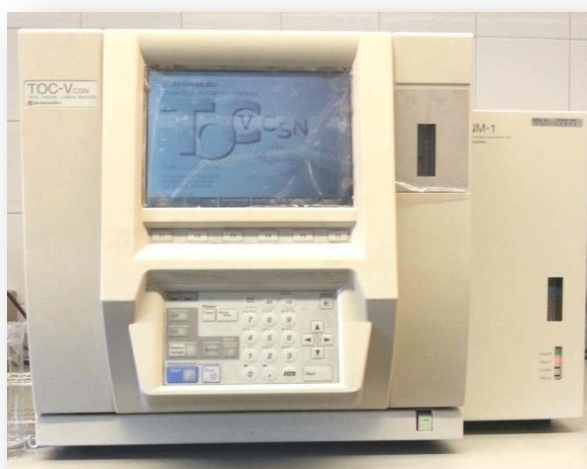
Figura 22. TOC-VCSN acoplado a un módulo TNM-1.
