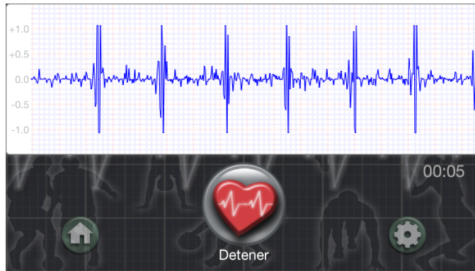
Figura 6. Exemple de registre obtingut a partir de l'eix Z de l'acceleròmetre intern d'un model d'iPhone 5 en el que s'hi poden observar els temps entre batecs cardíacs consecutius corresponents als intervals R-R.
