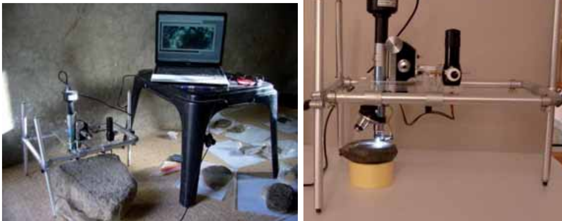
Fig. II.5.2. Microscopio portátil para el análisis de objetos de grandes dimensiones. La toma de microfotografías se realiza mediante la conexión a un ordenador y con el software informático ScopePhoto®.
