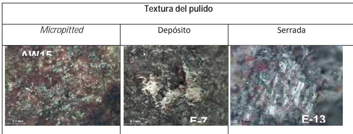
Fig. II.5.9. Textura del pulido: micropitted, depósito, serrada.
