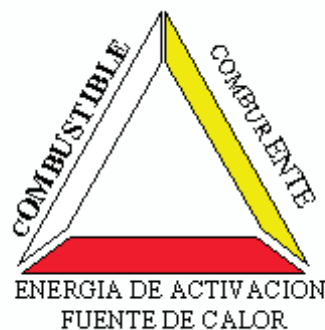
Esquema A IX.3. Triángulo de fuego en el que "no" hay combustible.
