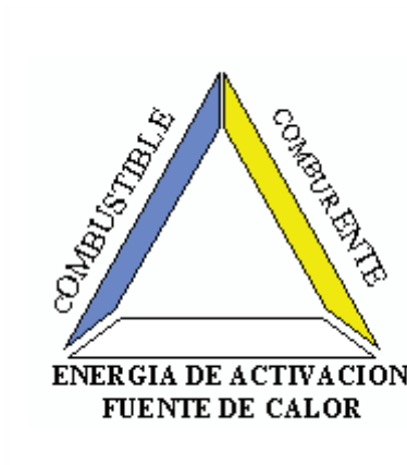
Esquema A IX.4. Triángulo de fuego en el que "no" hay energía de activación.
