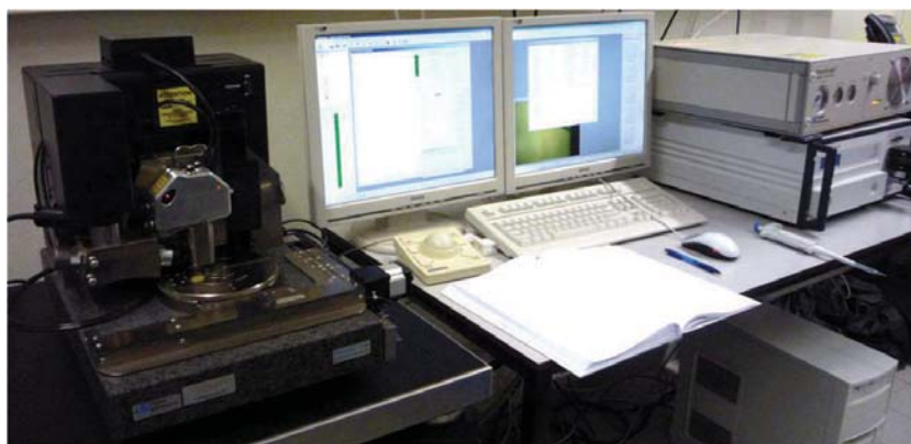
Figura 3.2 Sistema del microscopio de fuerza atómica Dimension 3100 SPM.
