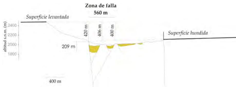
Fig. 5. 21 Esquema con el cálculo del salto considerando la zona de falla completa. Al medir el desplazamiento vertical de las superficies en el punto medio de la zona de falla, se obtiene un valor de 406 m, inferior a los 420 m medidos sobre la traza principal de la FNM.
