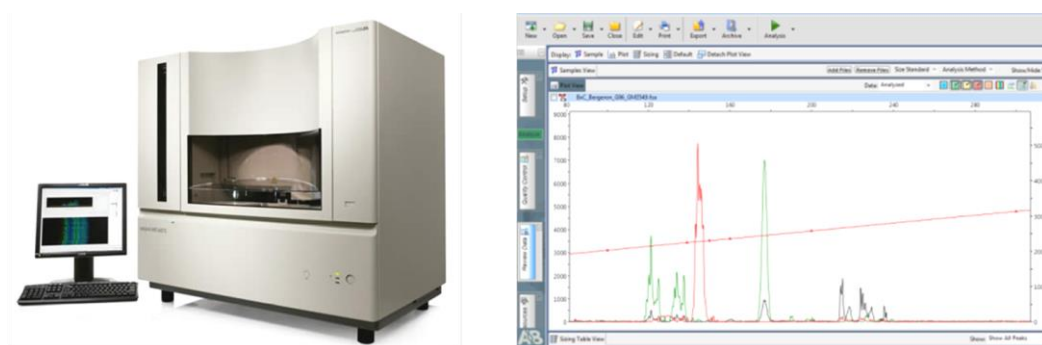
Figura 6.2. Secuenciador automático ABI Prism-3730 de 96 capilares y visualización de fragmentos de ADN en el software Peak Scanner 1.0.
