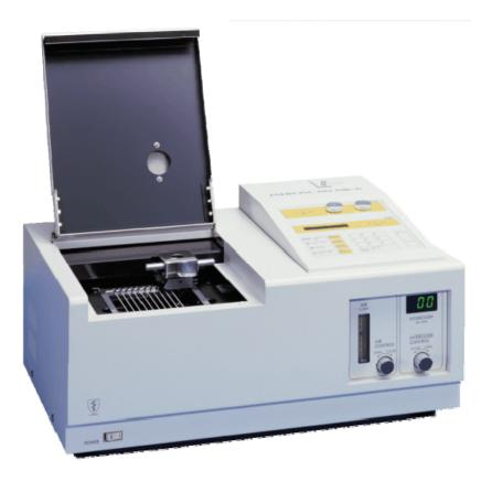
Figura V-2 Equipo latroscan® utilizado para el análisis TLC-FID.
