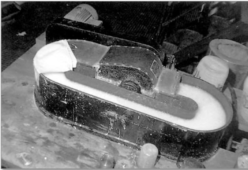
Ilustración 31. Refinadora de cilindro o pila holandesa. Ministerio de educación, cultura y deporte (2012)
