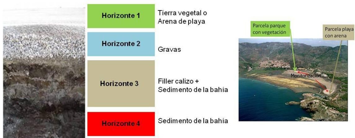
Figura 4. 2. Esquema con el perfil del Tecnosol piloto y situación de las parcelas piloto en la bahía (Martínez Sánchez y Pérez-Sirvent, 2009).
