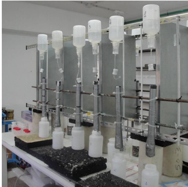
Figura 5. 3. Montaje final de las columnas.
