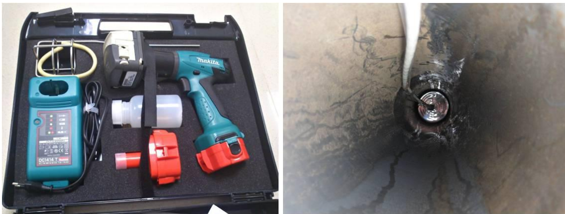
Figura 5. 9. Taladro con bomba peristáltica y extracción de una muestra líquida en uno de los pozos de la barrera.
