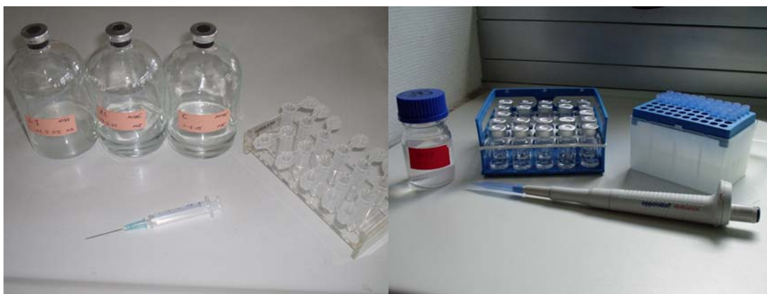
Figura 26.- Material necessari per a la realització d'estudis de degradació aeròbica en microcosmos.
