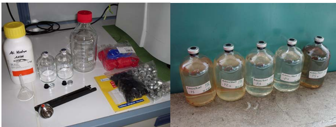
Figura 27.-Material per la presa de mostres per a l'anàlisi de MTBE per CSIA.
