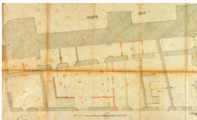
188. Casa del Arcediano. Planta baja. Proyecto de Josep Garriga i Garriga, 1871. El color rojo indica la parte añadida. Fuente: COAC, Fondo Elies Rogent, Exp. C - 308 / 293.
