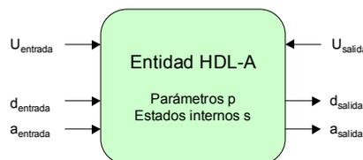
Figura 12. Esquema de una entidad HDL-A.
