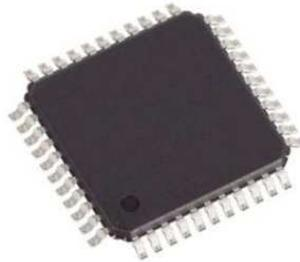
Figura 3.5. *Microcontrolador dsPIC33FJ128MC804, fuente: Microchip Inc.*
