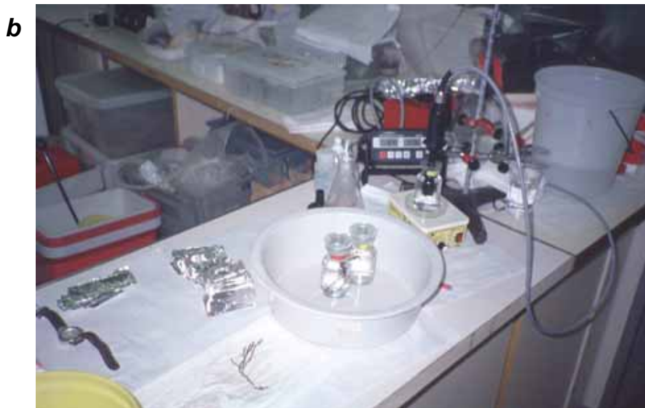
Figura 5.8. Incubacions fotosíntesi-irradiància al laboratori: (a) Arcó incubador amb les ampolles dels experiments de fotosíntesi irradiància. Les diferents irradiàncies s'aconsegueixen per distribució en zones amb il·luminació diferencial dins l'arcó i per l'addició de filtres reductors de la irradiància a sobre de les ampolles que així ho requereixen. (b) Detall de les ampolles d'incubació, oxímetre i agitador magnètic portàtil de camp i laboratori. El filament sobre la taula correspon a Alsidium corallinum .
