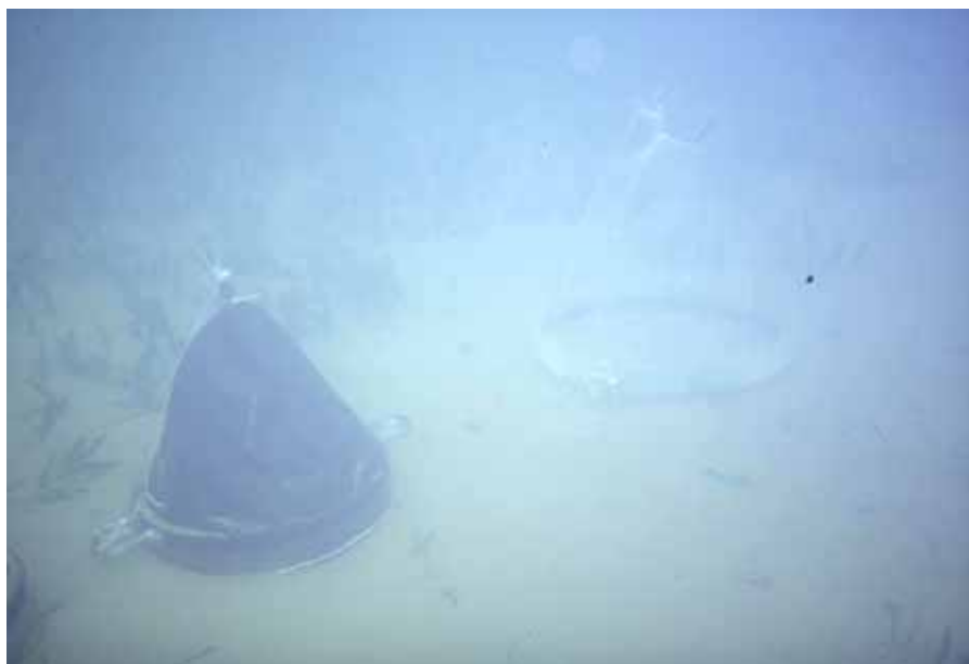
Figura 5.10. Campanes d'incubació de sediment (disseny propi). La campana s'enterra fins a una cota de 5cm de fondària del cilindre rigid, amb l'ajut de les nanses laterals que porta acoblades. El volum tancat al seu interior per aquest procés és d'11 l i la superfície plana és de 755 cm 2 . El con de PVC flexible permet que el corrent marí pugui moure l'aigua tancada en el seu interior trencant els possibles gradients que s'hi poguessin formar eventualment.
