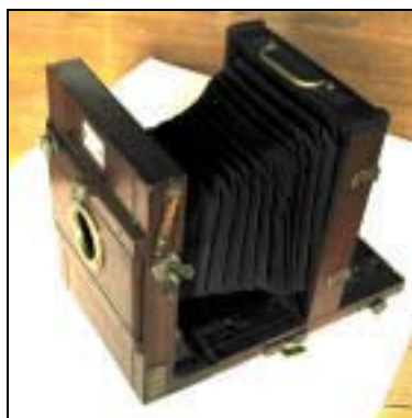
Cámara Busquets y Durán , 13x18, cerrada y abierta de perfil. El movimiento de enfoque es manual.
