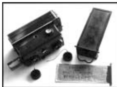
Cámara Vérascope , chasis cargado y calibre para portaplacas.
