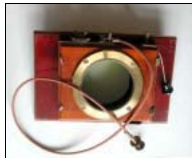
Soporte del objetivo Tessar para la cámara Globus . Obturador Thornton-Pickard . Tablilla adaptable a la cámara Globos
