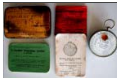
Caja metálica original. Sobre de papel sensible. Librito de instrucciones. Tríptico con la lista de la rapidez de placas. Actinómetro "Pose-Metre"
