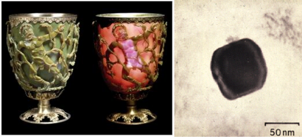
Figura I.13. Copa de Licurgo: al introducir una fuente luminosa en su interior el color pasa de verde a rojo intenso (izquierda) e imagen de una de las nanopartículas de oro presentes en el vidrio de la copa (derecha). 45
