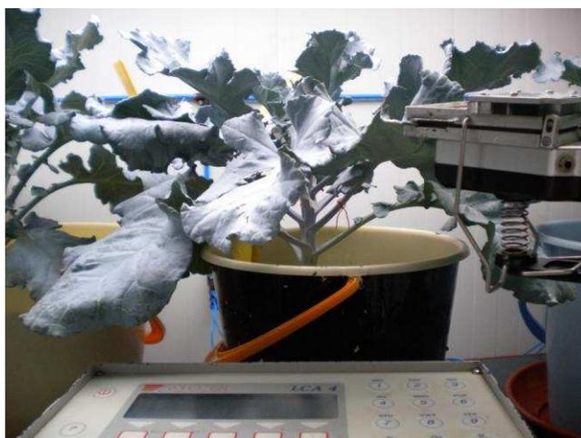
**Figura 3.6.** Sistema portátil de medición de fotosíntesis.
