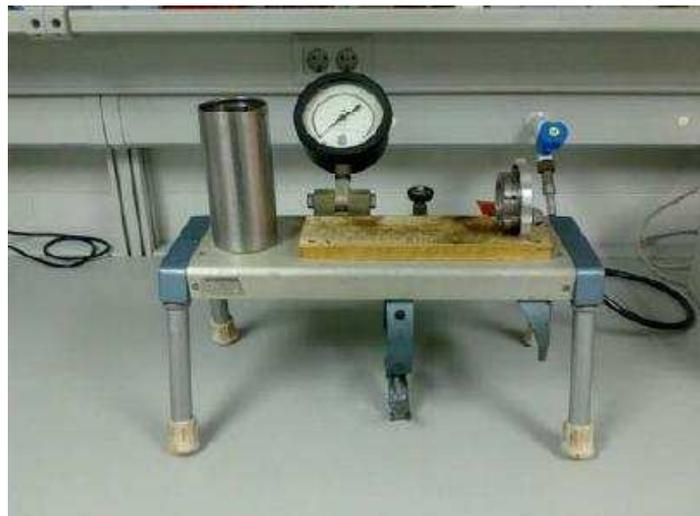
**Figura 3.7.** Cámara de Scholander para la determinación de la L<sub>0</sub>.
