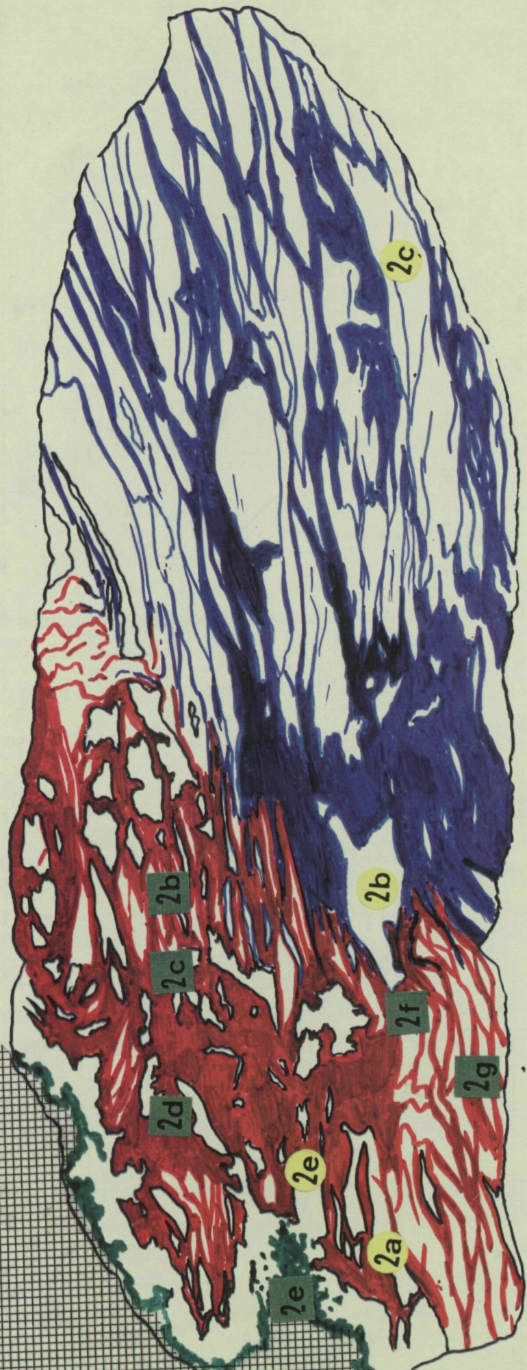
Fig. 8.6.9B.- Esquema de la fotografia de la Figura 8.6.9A, on es mostra la situació de les clorites analitzades per espectroscòpia mósbauer i de les anàlisis isotòpiques de C i O. Llegenda: 1- Arsenopirita massissa, 2- Clorita II ± III, 3- calcita i/o marbre, 4- Zona de la clorita ± (moscovita + feldspat potàssic), 5.- Zona de la muscovita + feldspat potàssic i zona del granat. 6.- anàlisis isotòpiques de C i O. 7.- anàlisi mósbauer.
