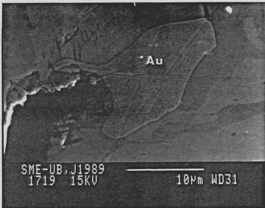
Fig. 8.6.14.- Fotografia amb microscòpia electrònica de rastreig d'un gra d'or del skarn sk-377.
