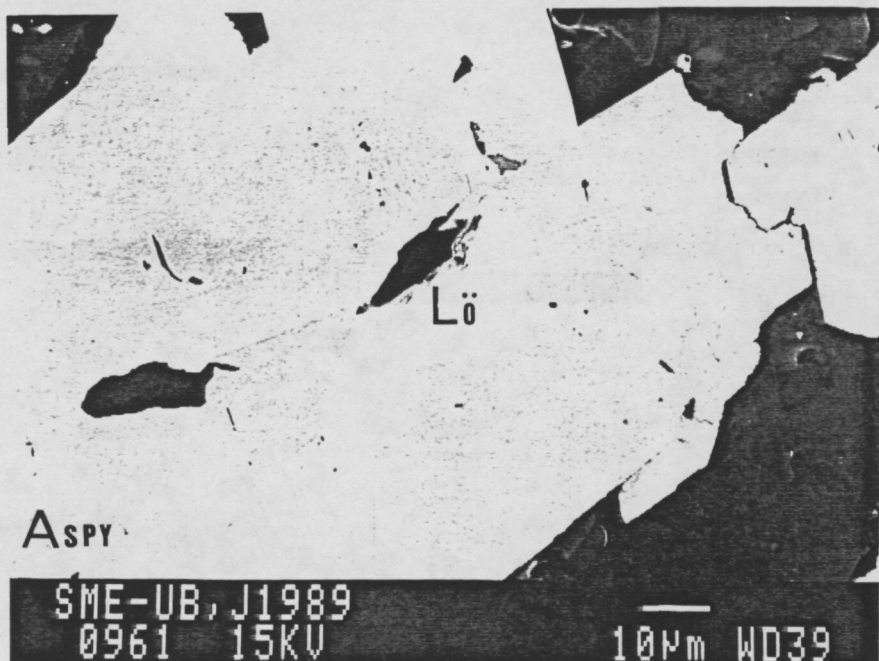
Fig. 8.4.13.- Fotografia al microscòpi de rastreig, on es mostra un relícte de löllingita a l'interior d'una arsenopirita del skarn Sk-9.
