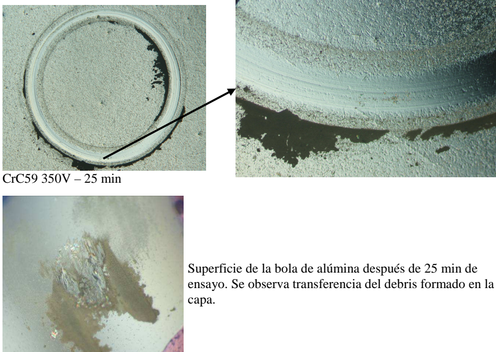
Figura 5.63. Evolución de la huella de fricción para la muestra CrC59 de la serie 6 depositada a un voltaje de polarización negativo de 350 V. También se muestra la superficie de la bola de alúmina después de 25 min de ensayo.
