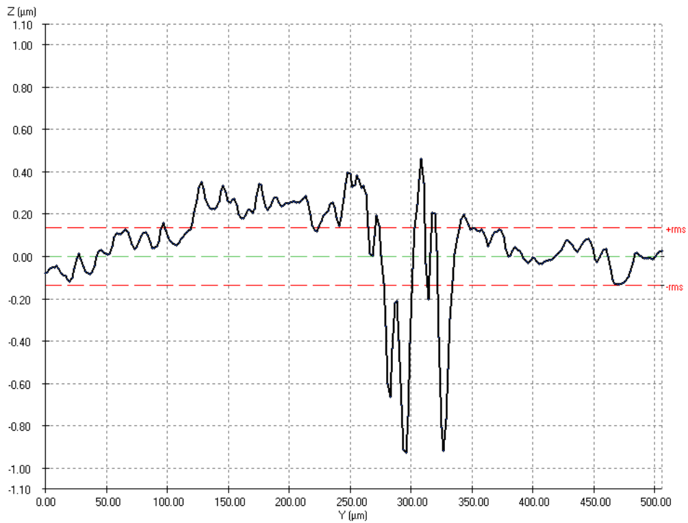
Perfil de la huella de desgaste del disco. No supera el espesor de la capa 1.5μm Cond. 1) 5N, 10Hz, 2mm y 20 min
