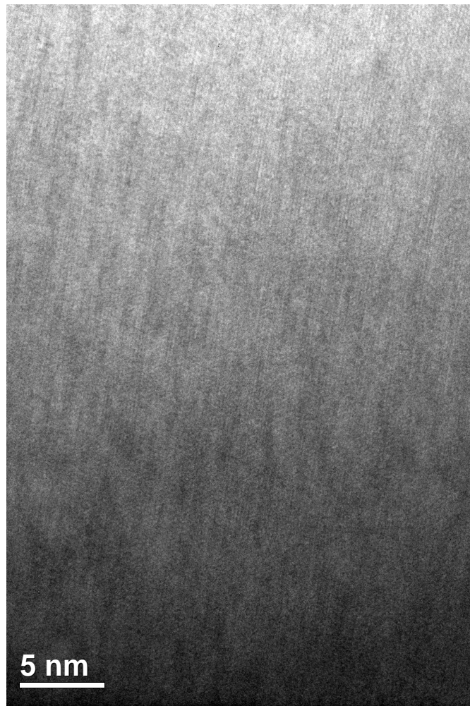
Figura 5.51. Micrografía HRTEM de la muestra CrC50 depositada a un voltaje de polarización negativo de 250 V.
