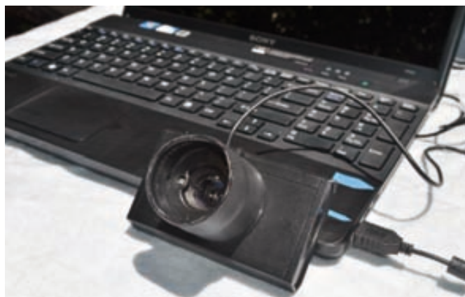
Figura 3. Equipo de lectura de iris para la especie canina ( www.k9eyescan.com )
