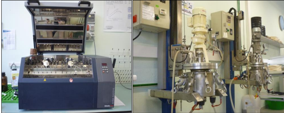
Figura 2.1. Reactor Easydye AHIBA de Datacolor: Tractaments, 2_2 i 2_4 . Reactor a pressió: Tractaments 3_4 i 4_4 .
